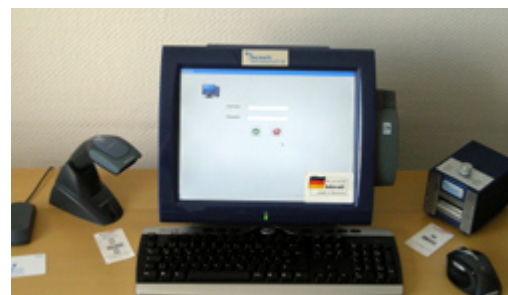
Bedienarbeitsplatz mit RFID-Tischleser, Barcode-POS-Leser, PC, Vergütungscodierer (von links nach rechts)
